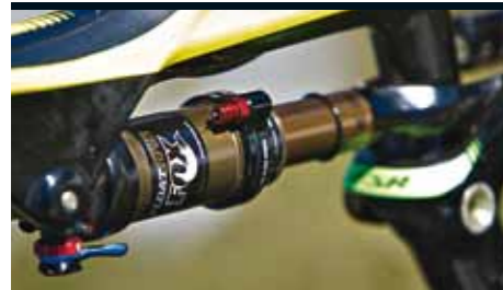
Oben: Das Autosag-Ventil am Kashima-be-schichteten Fox RP23 erleichtert Laien das Setup. Unten: Remote-Hebel der Vario-Stütze integriert im Schraubgriff – clever!
