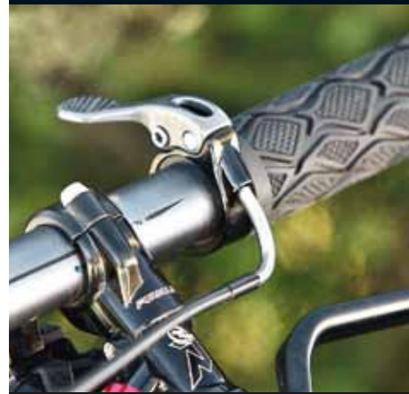
Oben: Das Autosag-Ventil am Kashima-be-schichteten Fox RP23 erleichtert Laien das Setup. Unten: Remote-Hebel der Vario-Stütze integriert im Schraubgriff – clever!
