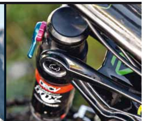
Oben: Für eine lineare Kennlinie sorgt die DRCV-Technik mit zwei Luftkammern – 2012 übrigens auch an der Gabel. Unten: Geometrie-Verstellung mittels „Mino-Link“.
